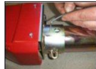
17. Drag åt fästskruv.
