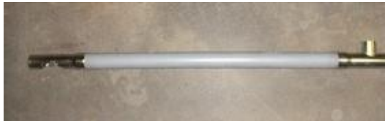
15. Skruvrör och T-rör sammankopplade.
