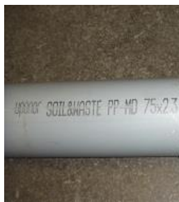
2. Tag fram ett 75 mm plaströr,
