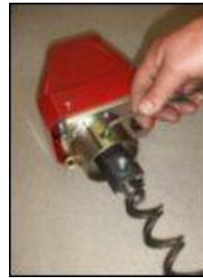
10. Drag åt den inre fästskruven genom det borrarade hålet.
