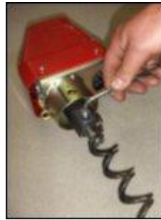
9. Drag åt den yttre fästskruven.
