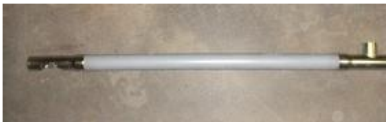
15. Skruvrör och T-rör sammankopplade.
