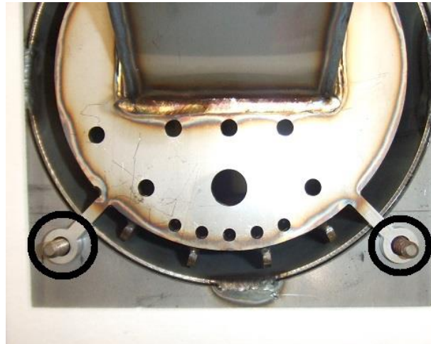
10. O.B.S ! När det inre brännarröret återmonteras måste båda styrtapparna hamna i hålen på brännarröret.
