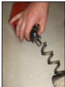
7. Montera fästbricka & skruv och gänga på skruvspiralen mot motor.
